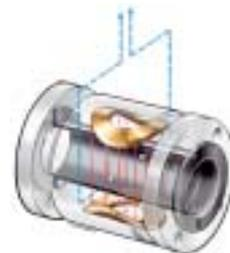
As bobinas do sensor geram um campo magnético consistente. O líquido que flui através do sensor induz uma tensão proporcional à velocidade do caudal.
