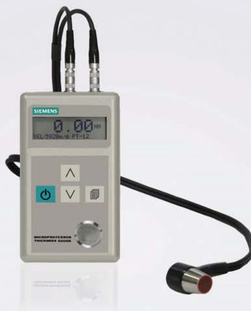
Este medidor de espesores por ultrasonido para paredes de tubería de Siemens es una herramienta de fácil manejo que resulta imprescindible para la medición ultrasónica no intrusiva de caudales. Para que un caudalímetro trabaje correctamente necesita obtener la medida exacta del espesor de las paredes de la tubería sobre la que está midiendo el flujo. El medidor de espesores para paredes tiene que ser suma-
