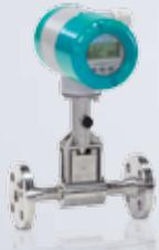
Caudalímetro compacto indicado para medir el caudal de vapor, gases y líquidos. La compensación de temperatura para vapor saturado viene instalada de serie, lo que permite compensar directamente la densidad.
