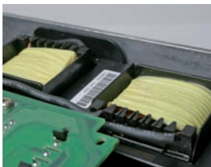
As bobinas CC reduzem o ruído de harmónicos e protegem o drive. Além disso, os filtros EMC estão integrados (conforme EN 55011 A2, A1 ou B).
